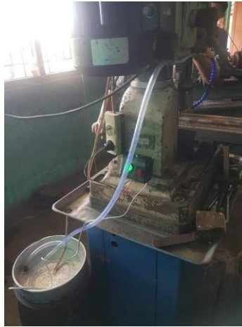
Gambar 4 Pemasangan Sistem Pendingin
